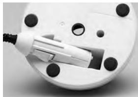
Csatlakoztassa a tápkábelt a hálózatra és a tápegséghöz. Győződjön meg arról, hogy a tápkábel könnyen hozzáférhető, és könnyedén kihúzható a konnektorból. A tápegségen lévő kijelzőn felvillan a „Bluephase G4” felirat egy rövid időre.
