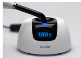
Za mjerenje intenziteta svjetla, postavite vrh vodiča svjetla, bez zaštitnog poklopca, u označeno udubljenje na gornjoj strani baze za punjenje. Potom uključite lampu i očitajte vrijednost prikazanu na rasponu. Točnost mjerenja je od  $+/- 10\%$ . Ako je intenzitet svjetla ispod  $400 \text{ mW/cm}^2$ , na rasponu će se prikazati "LOW" (Slabo). Intenzitet svjetla lampe za polimerizaciju mjerite isključivo s pomoću isporučene odgovarajuće baze za punjenje.
